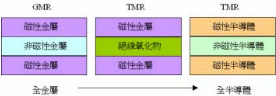
圖八、磁阻式多層膜之型式。
